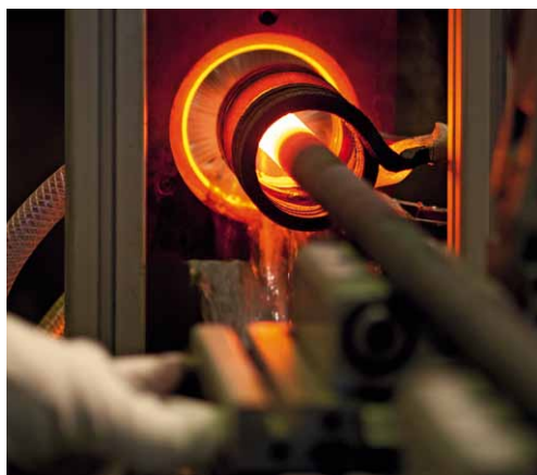
Induktives Härten der Meißel Inductive tempering
